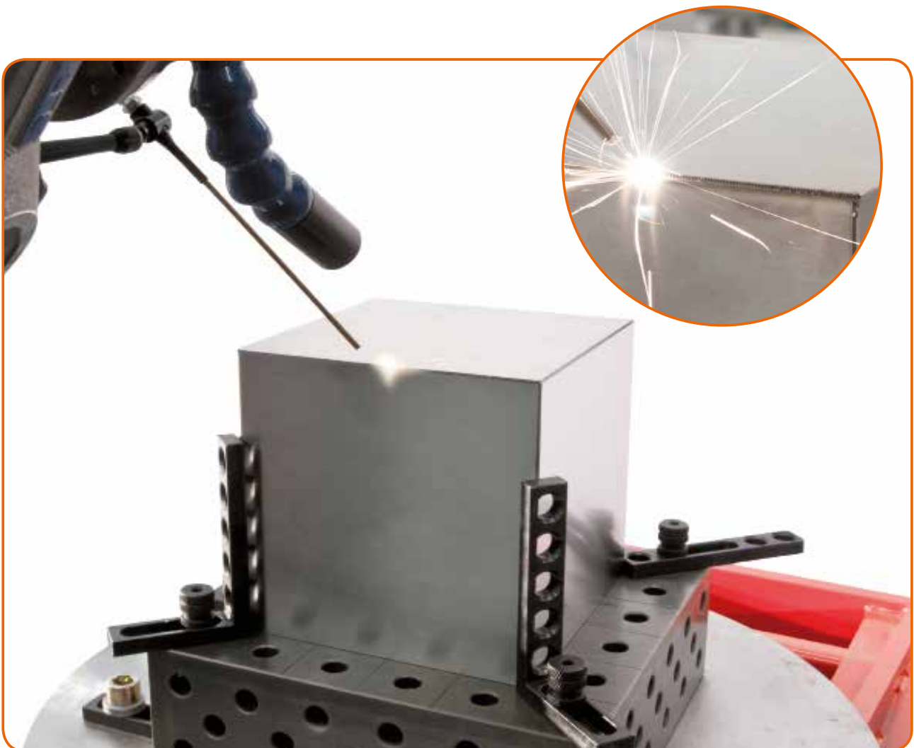
Producción de muestra para cliente. Soldadura láser de carcasa de acero inoxidable
