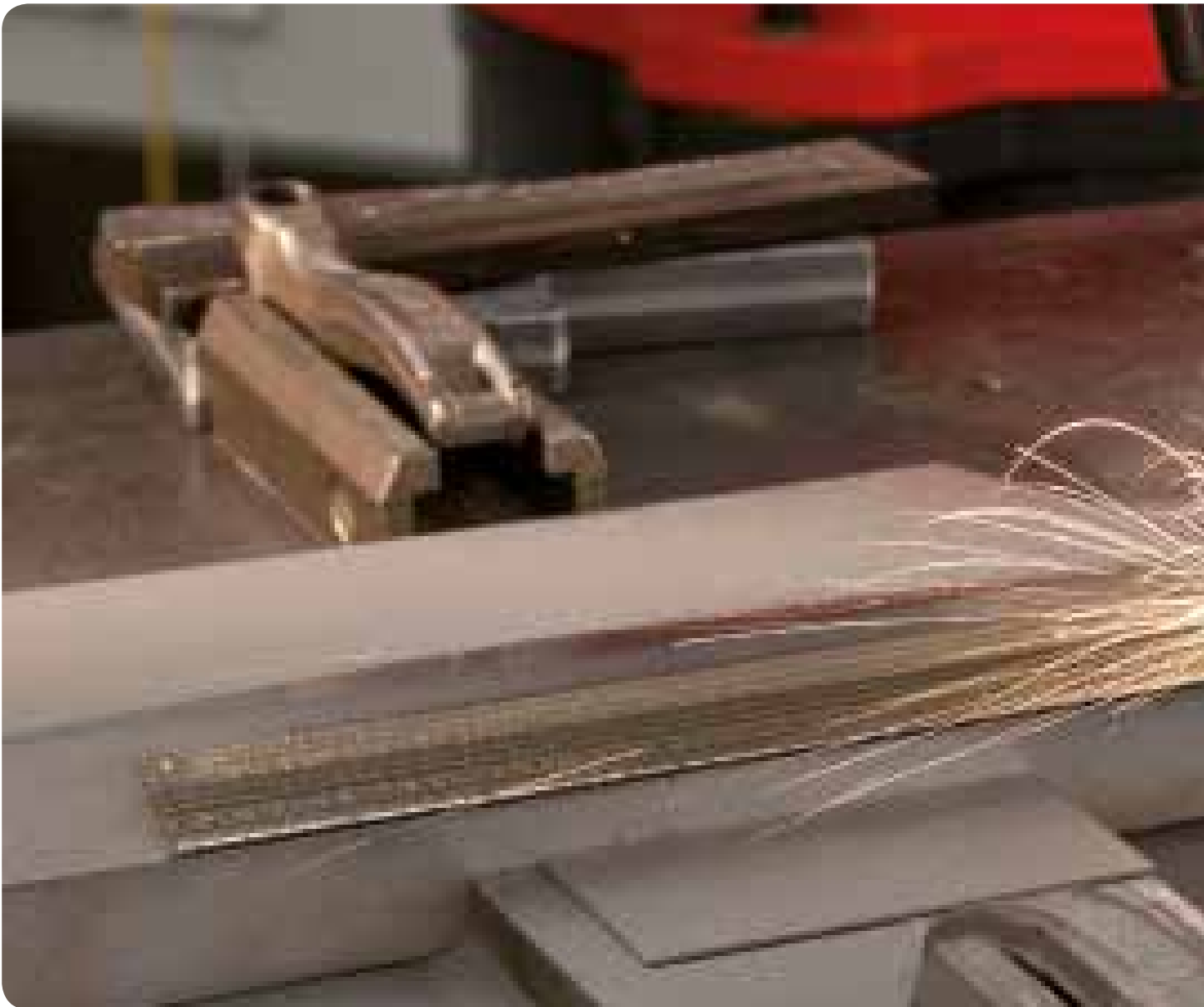
Aplicación de una capa de protección contra desgaste en un cuchillo mediante revestimiento de polvo láser.
