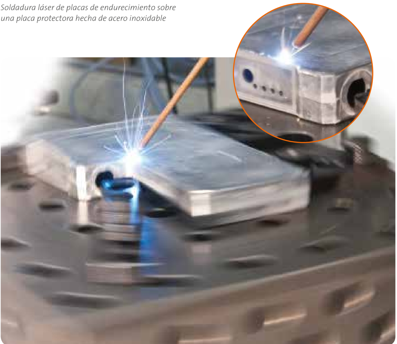
Soldadura láser de la tapa de una carcasa de batería hecha de una aleación de aluminio
