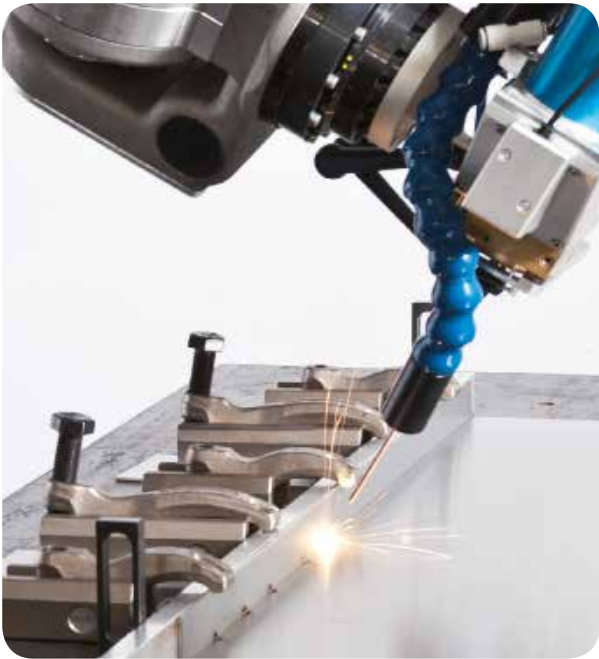
Soldadura láser de placas de endurecimiento sobre una placa protectora hecha de acero inoxidable
