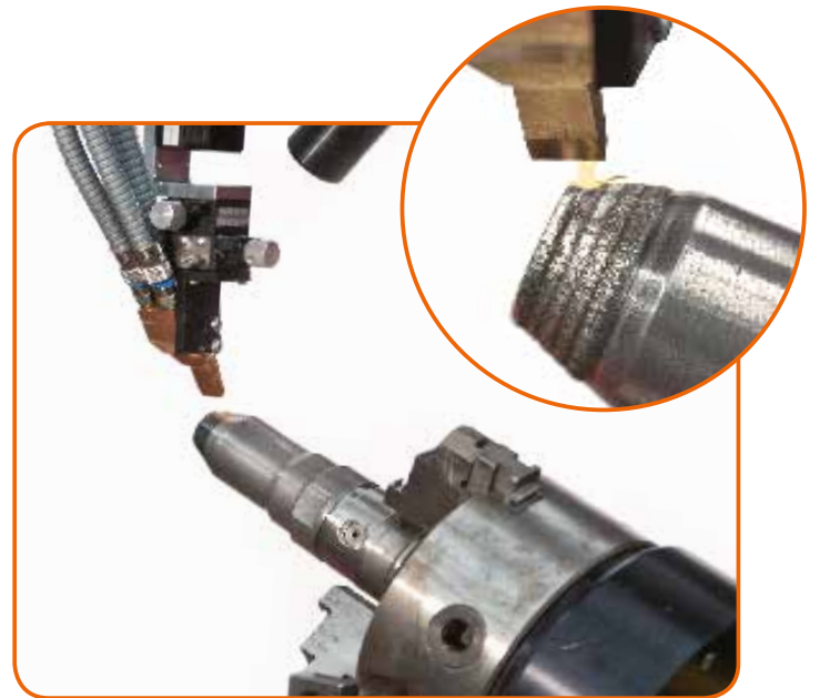
Capa de reparación de una boquilla de inyección mediante revestimiento de polvo láser
