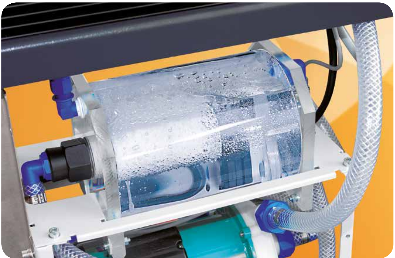
El sistema interno de enfriamiento de agua-aire garantiza una calidad de rayo homogénea.
