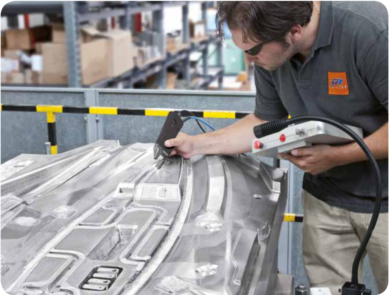
Soldadura de reparación en un molde de inyección
