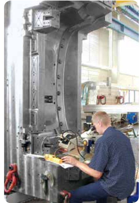
Procesamiento de un molde de 20 t para la producción de defensas de automóviles
